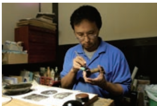
香合（香料の容器）に、漆で波の模様を描く「蒔絵」の工程。漆器の状態に合わせて、適した筆を使い分けるのだという。
